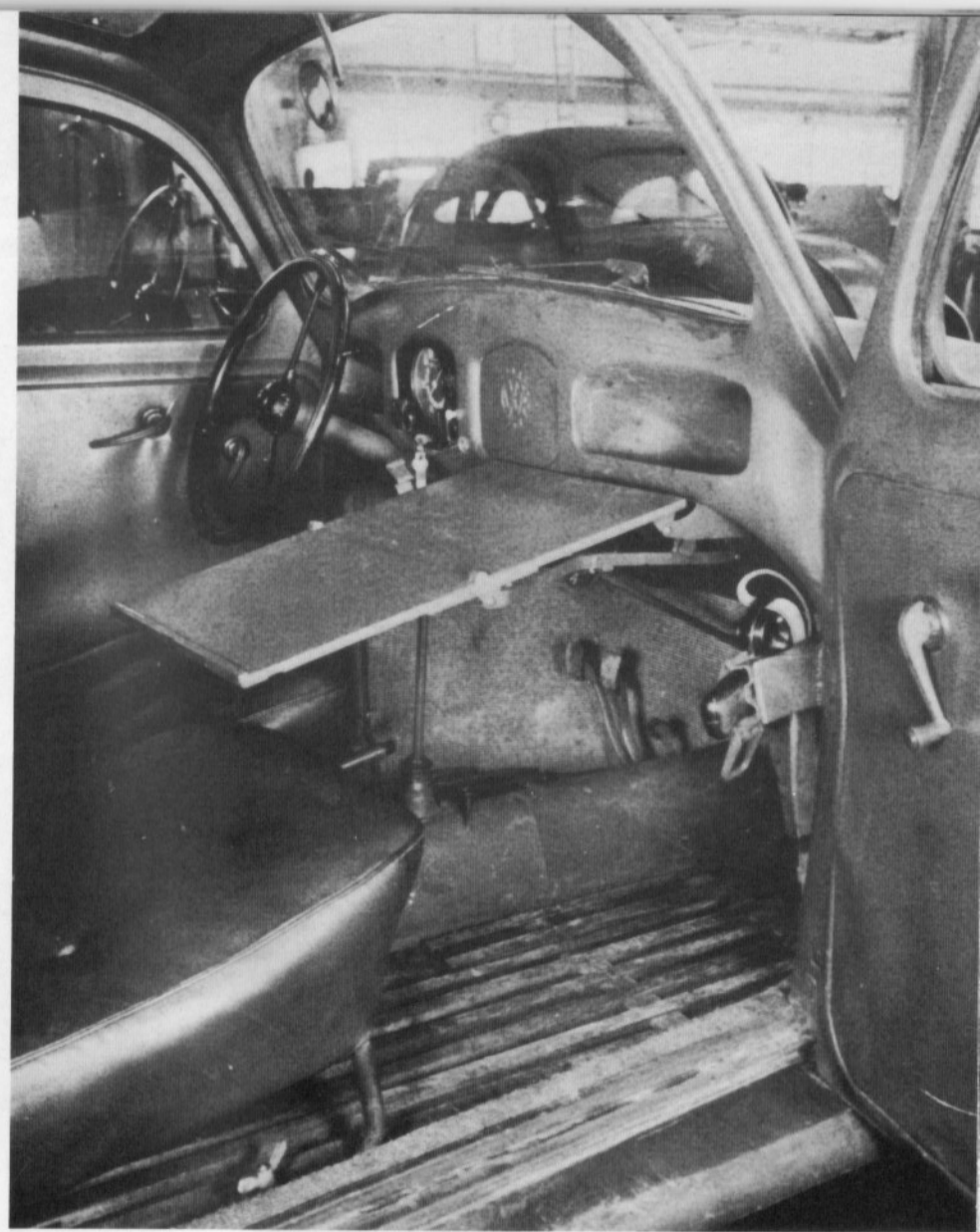
Armaturenbrett mit ausziehbarer Schreibunterlage beim VW Typ 82 E (auch Typen 92 SS und 87). Im Fußraum rechts ist die Maschinenpistole zu erkennen. Auf dem Boden sind Holzroste wie im Kübelwagen. Die einfache Befestigung der Sitze mit Flügelschrauben gab es beim VW-Standard noch bis 1965.
