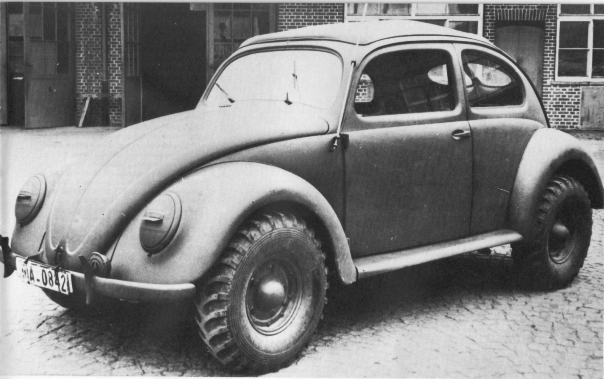
VW-Gelände-Limousine mit Vierradantrieb (Typ 87). Das Fahrzeug hat verbreiterte Kotflügel und Trittbretter, um für die großen Geländeräder Platz zu schaffen. Der Typ 87 hatte serienmäßig ein großes Faltschiebedach. Von 1941 bis 1944 wurden 564 Fahrzeuge gebaut; der größte Teil davon ging an das Afrikakorps.
