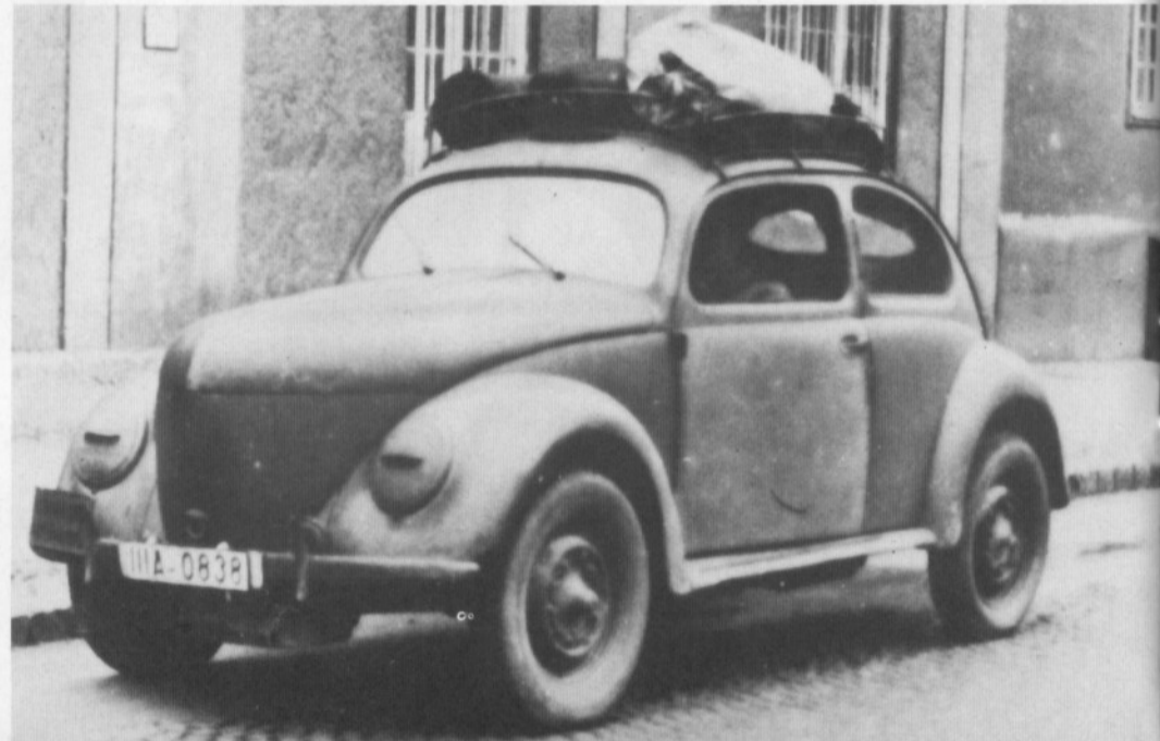
Unten: Eine VW-Geländelimousine (Typ 82 E) mit einer eingebauten Holzgasanlage. Dieses außergewöhnliche Fahrzeug war 1944 im Hausfahrdienst der Firma Porsche eingesetzt.
