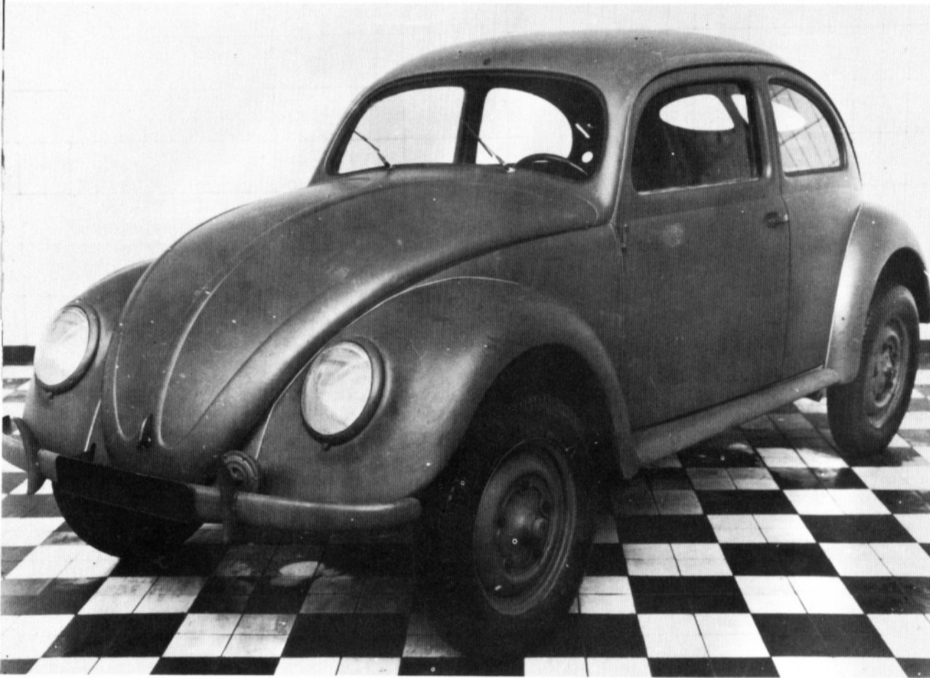
Die VW-Gelände-Limousine mit der normalen Karosserie des KdF-Wagens und dem hochbeinigen Fahrgestell des Kübelwagens nahm auch ohne Allrad-Antrieb fast jedes Hindernis. Gebaut wurde dieser Typ von 1941 bis 1946.
