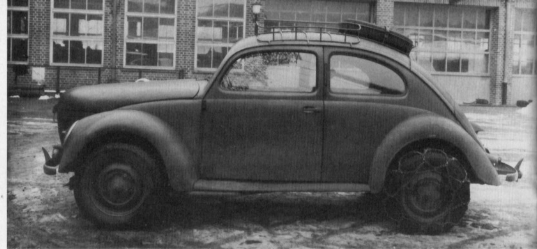
Oben: Gelände-Limousine mit Holzgasanlage (Typ 230). Der Generator ist durch eine besondere Verkleidung verdeckt. Mit der Getriebeuntersetzung des Kübelwagens und den Schneeketten ist dieses Fahrzeug auch für extremen Winterbetrieb gut geeignet. Baujahr 1944.
