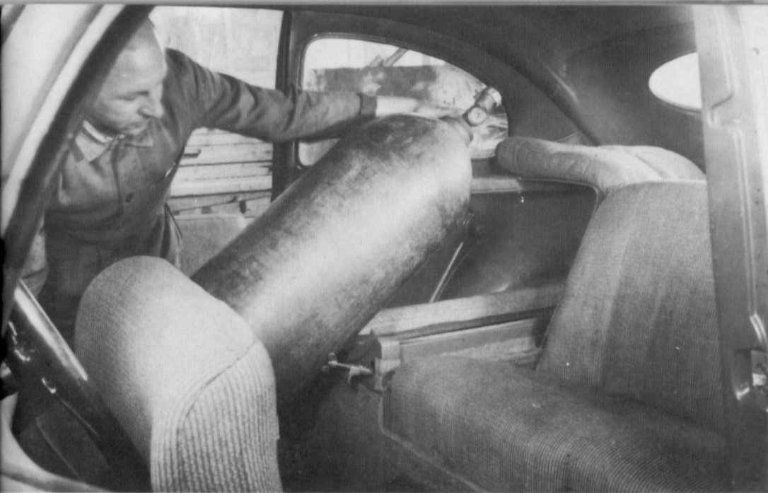
Oben: Einbau einer Gasflasche neben dem Rücksitz.
