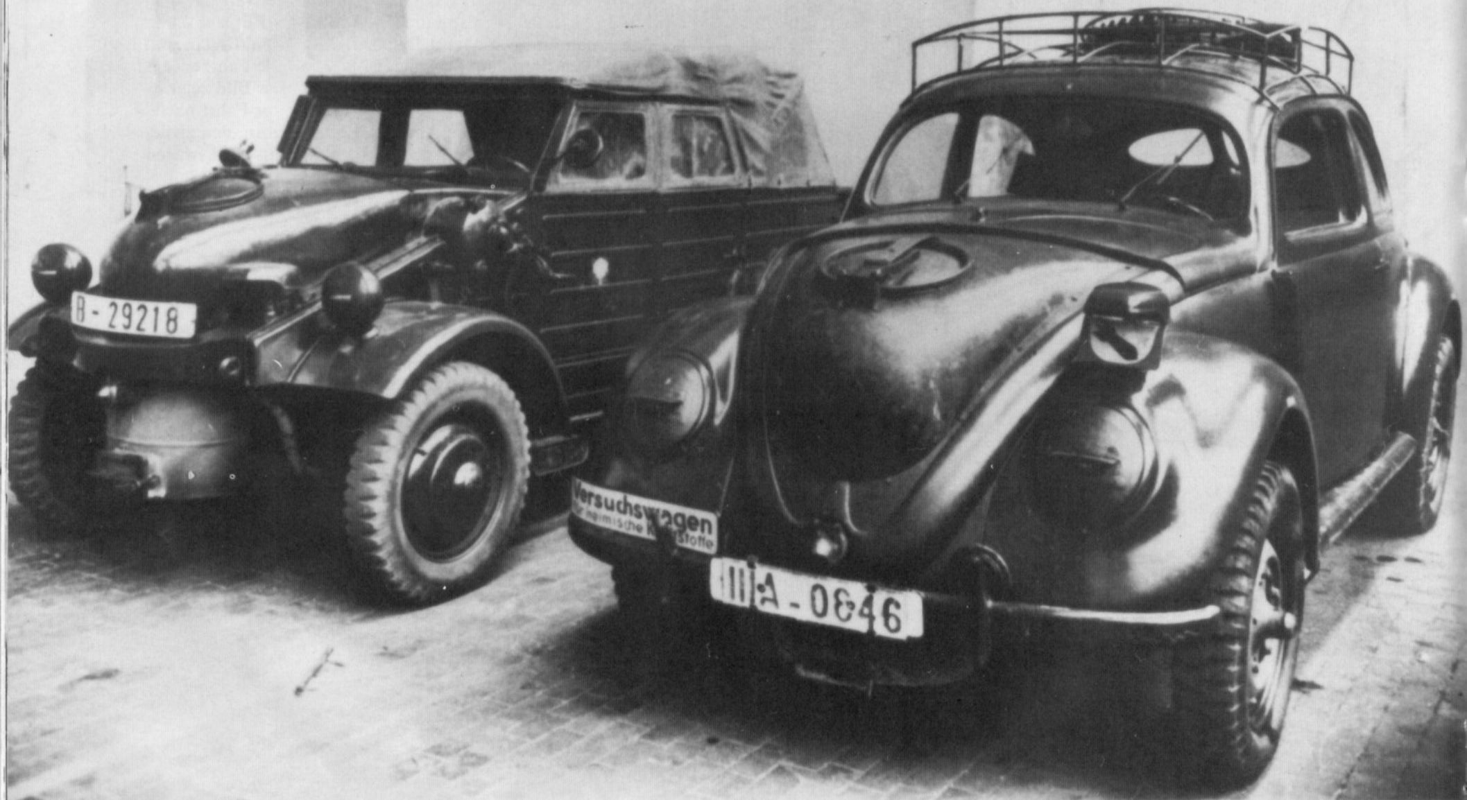
Aufgrund der prekären Treibstoffsituation gegen Ende des Krieges wurden viele Fahrzeuge auf Holzgasbetrieb umgestellt. Auch diese beiden Wehrmacht-Volkswagen haben Generatorbetrieb, daher die voluminöse Aufwölbung der Wagenfront. Links der VW-Kübelwagen, rechts eine VW-Geländelimousine.
