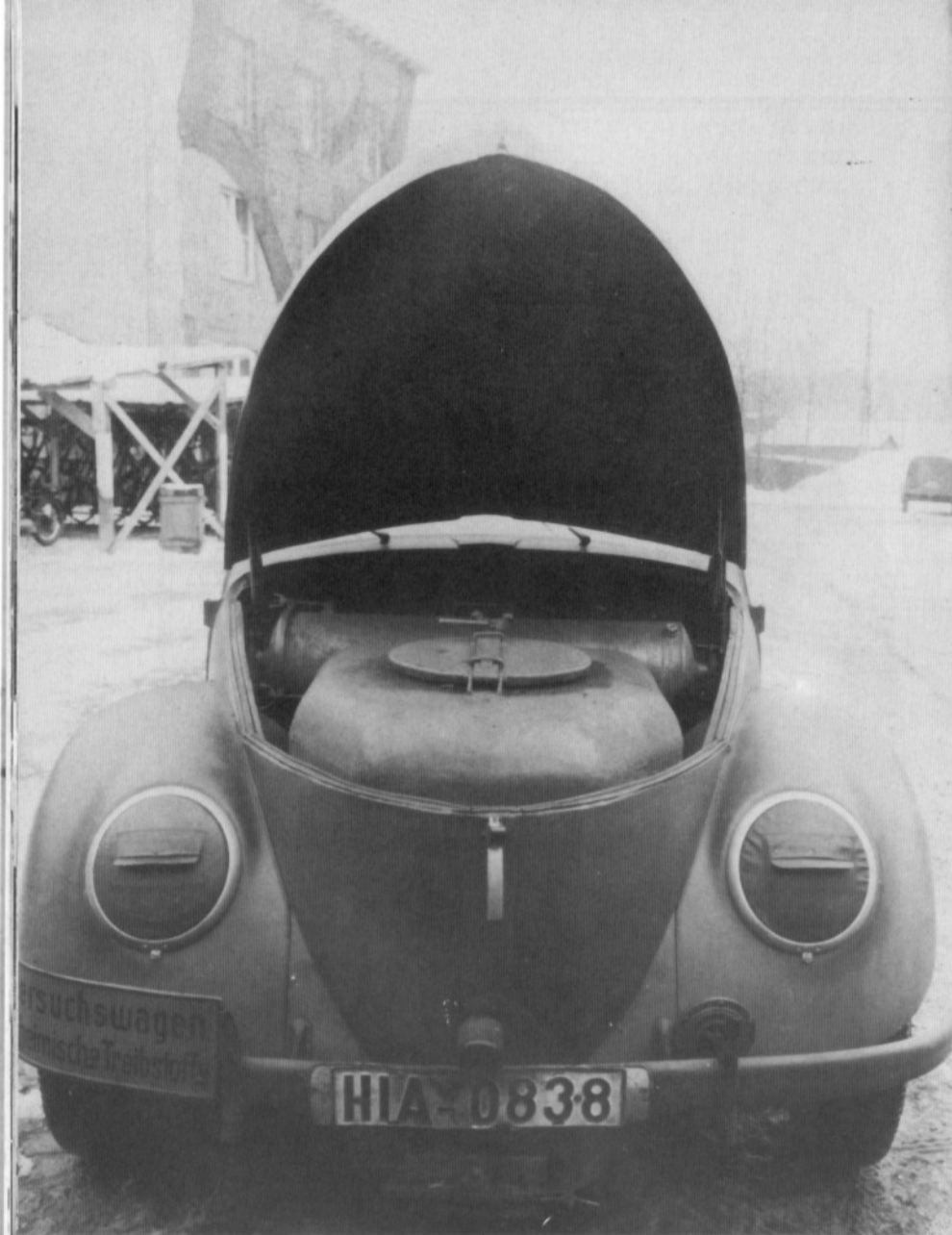
Die geöffnete Haube der verlängerten Frontpartie läßt einen Blick zu auf den Generator und den Vorreiniger.
