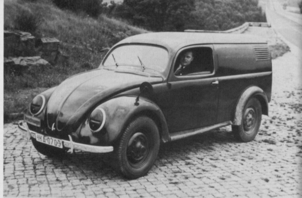
Der VW-Kastenwagen (Typ 81) als Versuchsfahrzeug auf der Reichsautobahn. Mai 1941. Es ist der sogenannte Tropenwagen auf Fahrgestell des Kübelwagens. Die Rückansicht mit geöffneter Tür zeigt den Motor unter der Ladefläche. Der Vergaser wurde seitlich gesetzt, um Ladehöhe zu gewinnen. Der Typ 81 ist ein Vorläufer des VW-Kleinlieferwagens, der von 1964 bis 1974 hauptsächlich für die Post gebaut wurde.
